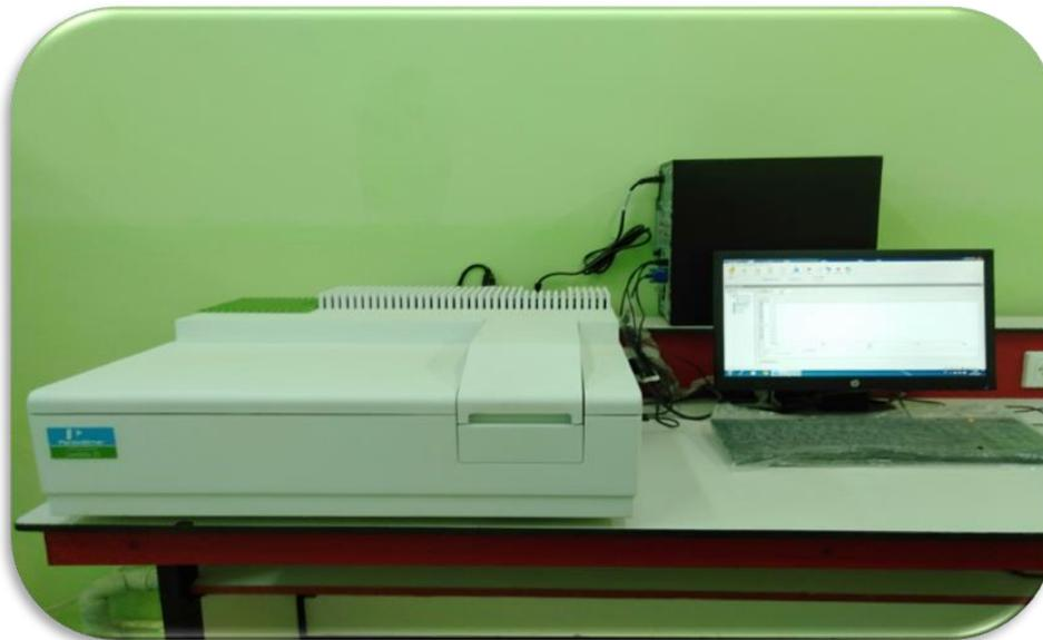
Fig.II-16 : Spectromètre UV-Visible de type "PerkinElmer UV Lambda 25".
