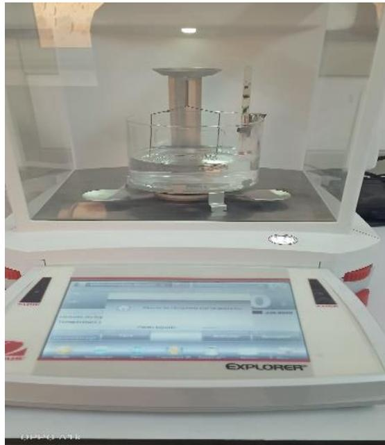
**Fig.II-11 : balance électrique (mesure directe).**
