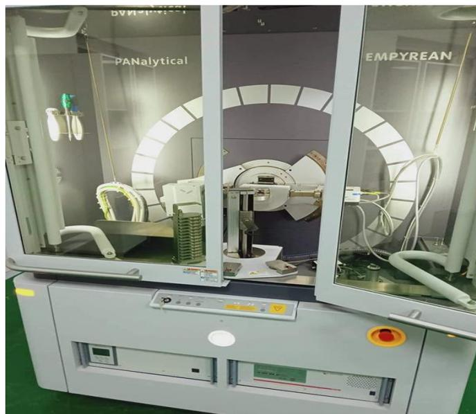
**Fig.II-10 : Diffractomètre à rayons X Empyrean.**
