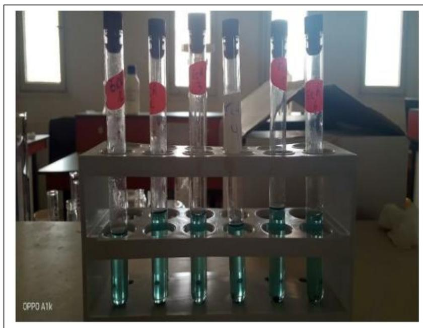
**Fig. III-9 : Solutions aqueuses avec catalyseur (LGFO(SF)) apr s teste de d gradation de BM sous lampe UV.**
