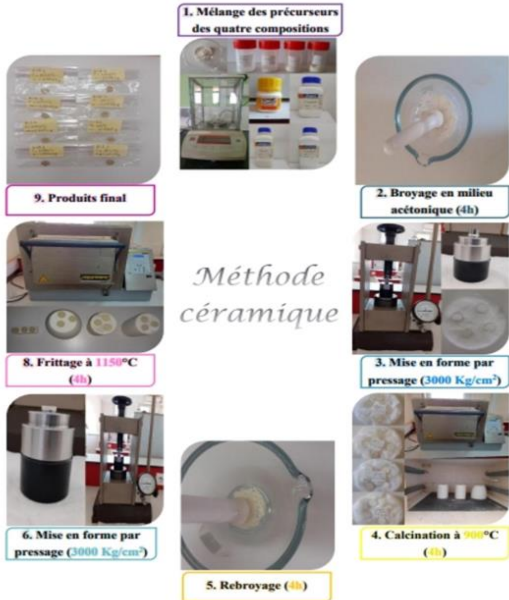
Figure II.5. Les étapes de synthèse du composé BNT par voie solide.
