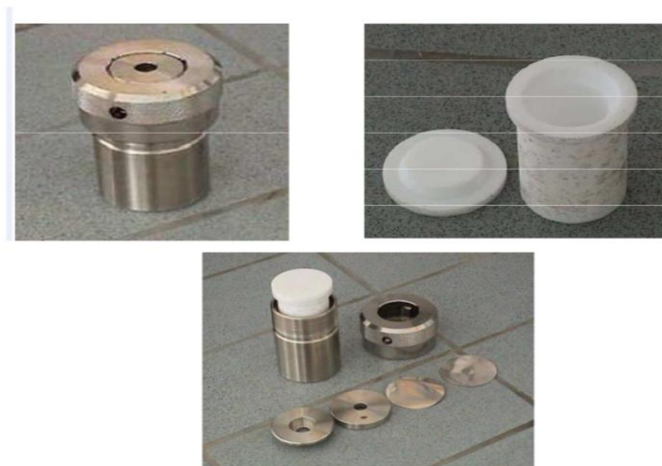
Figure II.12. Un Autoclave et ses principaux composants
