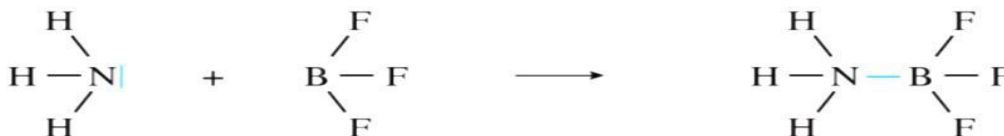
Figure7: structure de Lewis de \text{NH}_3\text{BF}_3
