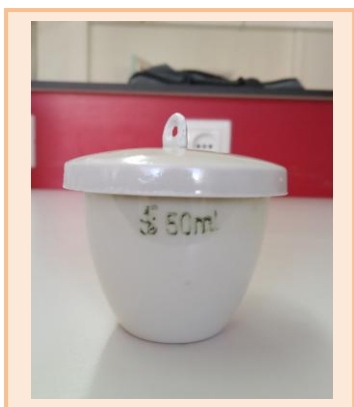
Figures III.4. Outil de Calcination a) Creuset en porcelaine b) Four a moufle pour la calcination)
