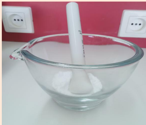
Figures III.3. Mélange et broyage des échantillons dans un mortier.
