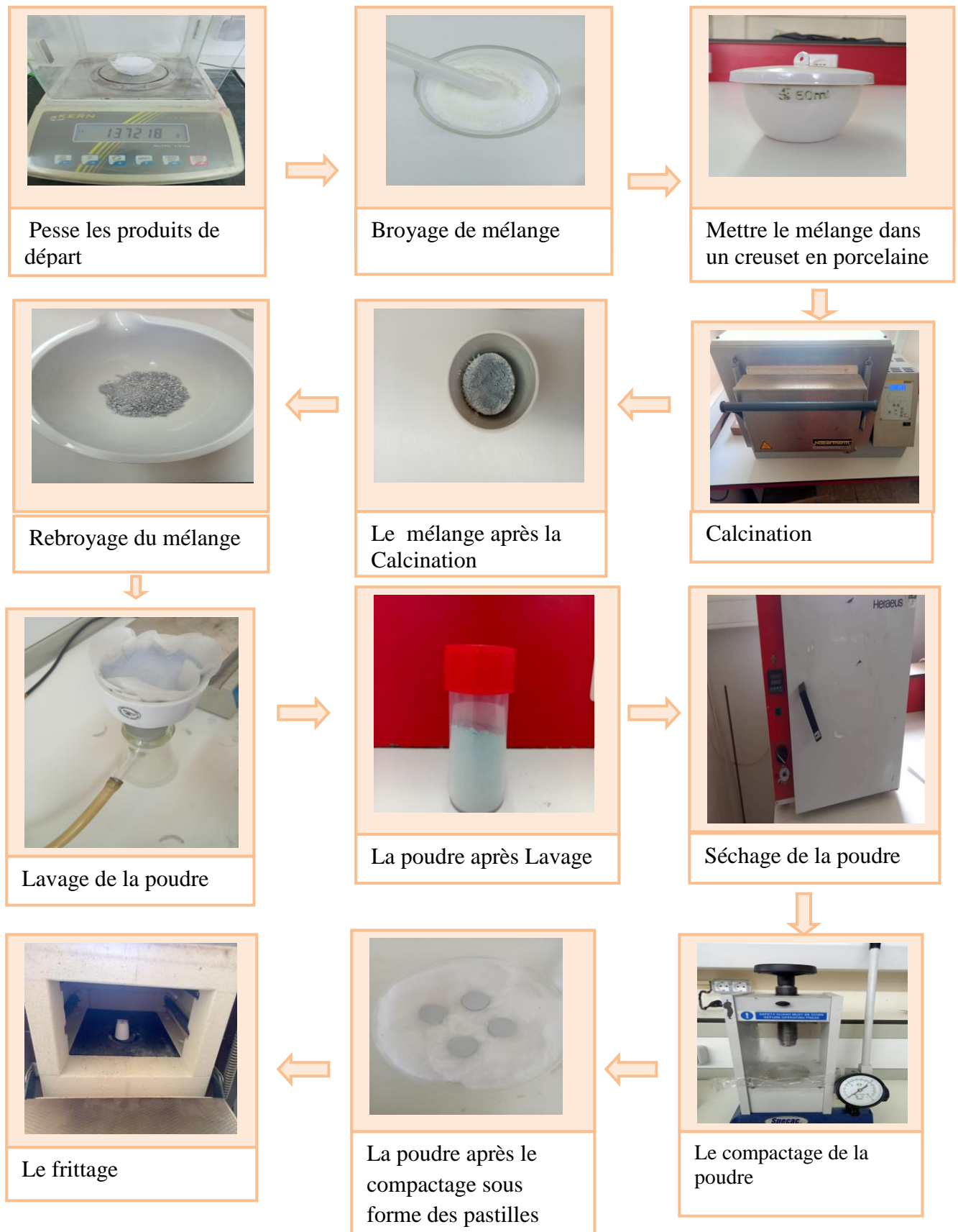
Figure III.8. Les différentes étapes de la méthode sel fondu.
