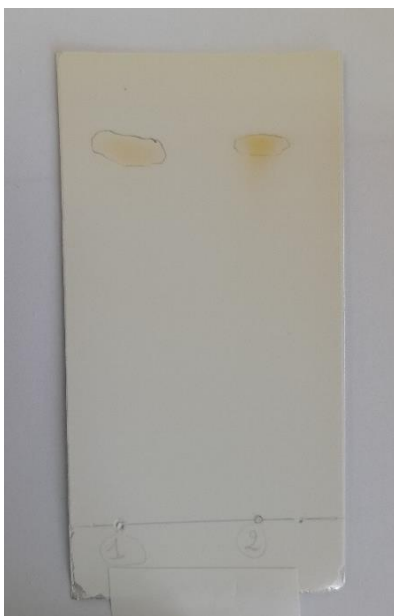
Figure III.9 : Résultat d'analyse CCM de dibenzylldènecyclohexanone.
