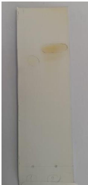
Figure III.7 : Résultat d'analyse CCM de Pyrazole II.
