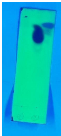
Figure II.9 : CCM de produit pyrazole I.
