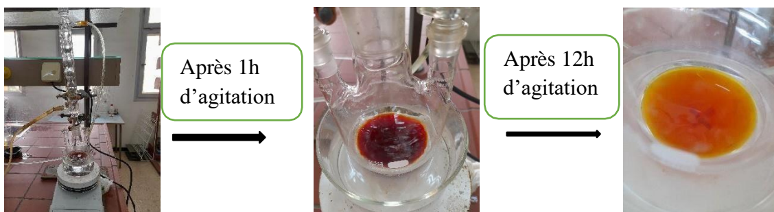
Figure II.18 : étape préparation de cyclisation (1E,4E)-1,5-bis(2- hydroxyphenyl)penta-1,4-dien-3-one
