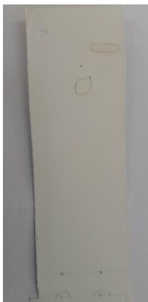
Figure III.1 : Résultat d'analyse CCM de dibenzalacétophénone.
