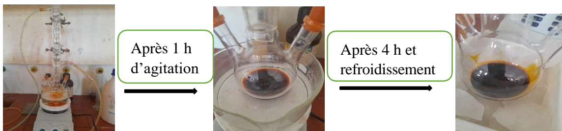
Figure II.15 : étape de préparation de (2E)-3-(2-hydroxyphenyl)-1-phenylprop-2-en-1-one
