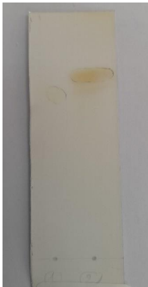
Figure III.5 : Résultat d'analyse CCM de dibenzylidèneacétone.
