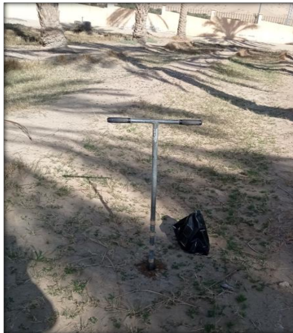
Photo 02 : prélèvement de sol par la Tarière
