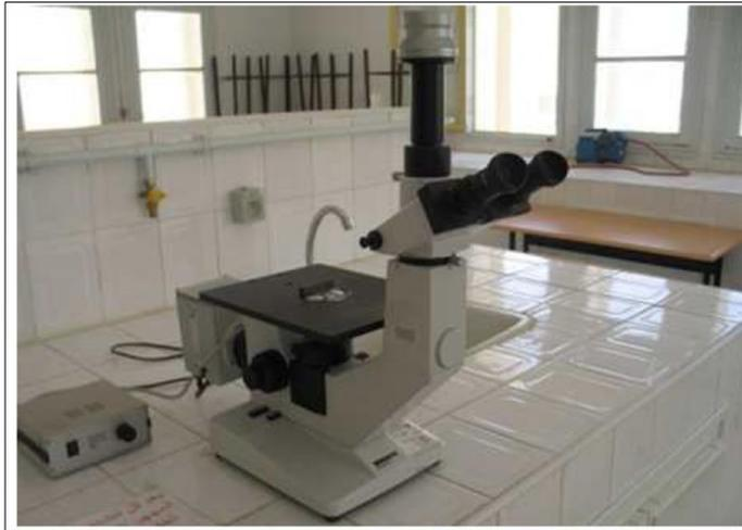
Figure II-4 : Microscope optique HUND T100-WETZLAR
