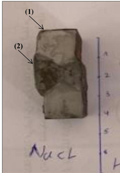
**Figure III.2 : Aspect macroscopique de produits de corrosion en milieu NaCl 3,5%**
