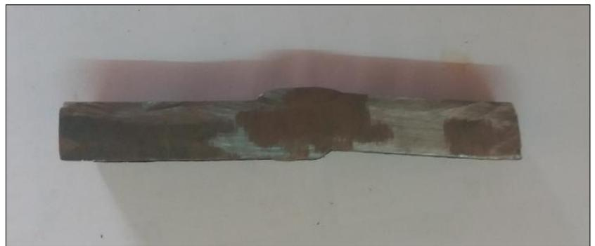
Figure III.17 : (a) Joint a soudé du pipeline Gazoduc « Projet GR7 », (b) Défaut d'alignement
