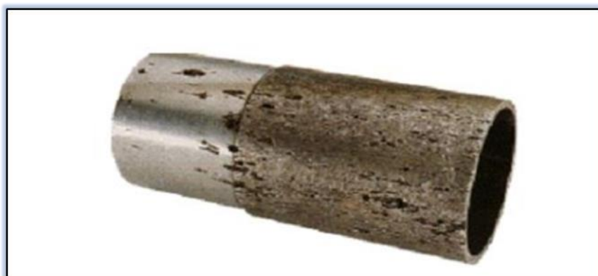
Figure (I.6) : Corrosion par piqûres d'un acier inoxydable[4]
