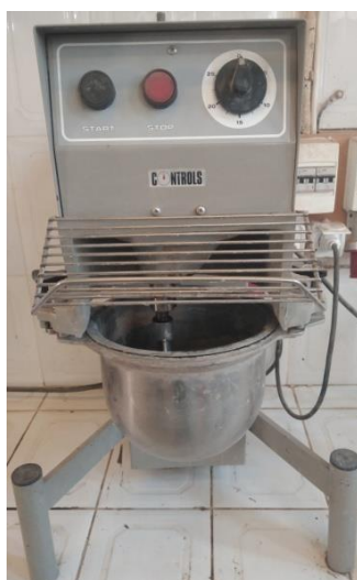
Figure II.13. Malaxeur électrique utilisé dans la fabrication de BPRF
