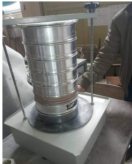
Photos 4 : Essais d'analyse granulométrique des éprouvettes 4X4X16 cm
