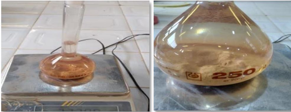
Figure II.9. La masse volumique absolue du quartz broyé. La masse volumique absolue (Méthode du pycnomètre) [NT 47-14 EN 196-1]
