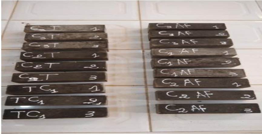
Figure II.16. Démoulage des éprouvettes et nomination des éprouvettes
