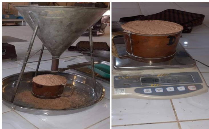
Figure II.3. Essai de détermination de la masse volumique apparente du sable
