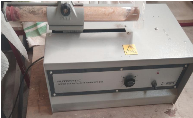
Photos 5: Essais d'équivalent de sable
