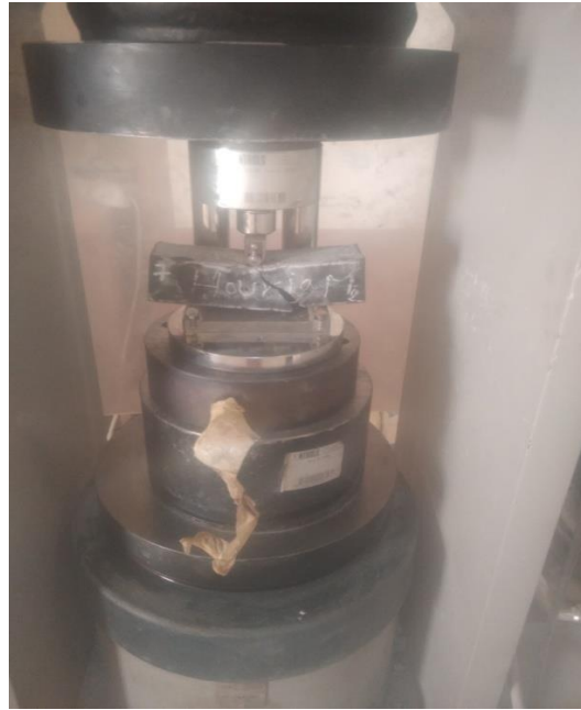
Photos 2 : Essais de traction par flexion sur des éprouvettes 4X4X16 cm
