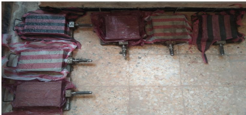
Figure II. 15. Eprouvettes protégées par film Plastique
