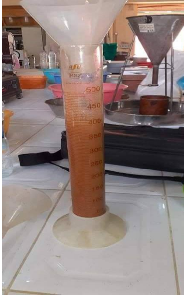
Figure II.2. Essai de la détermination de la masse volumique absolue du sable.
