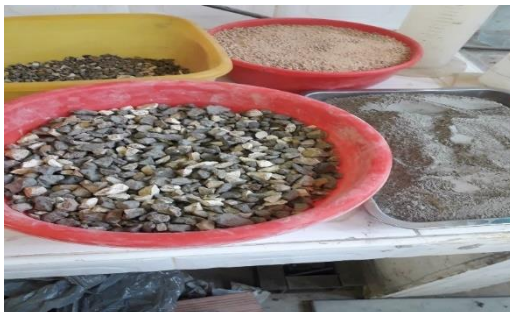
Fig4.3 Les constituants solides du béton
