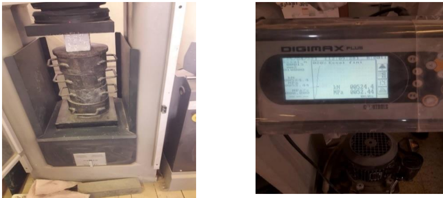
Figure 4.11 Appareil la Presse de Compression du béton.
