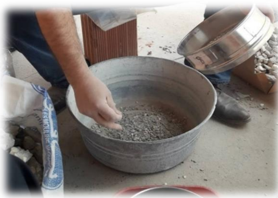
Figure 3.6 Concassage et Tamisage Manuel
