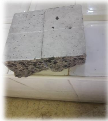
Figure 4.19 éprouvette après la traction.
