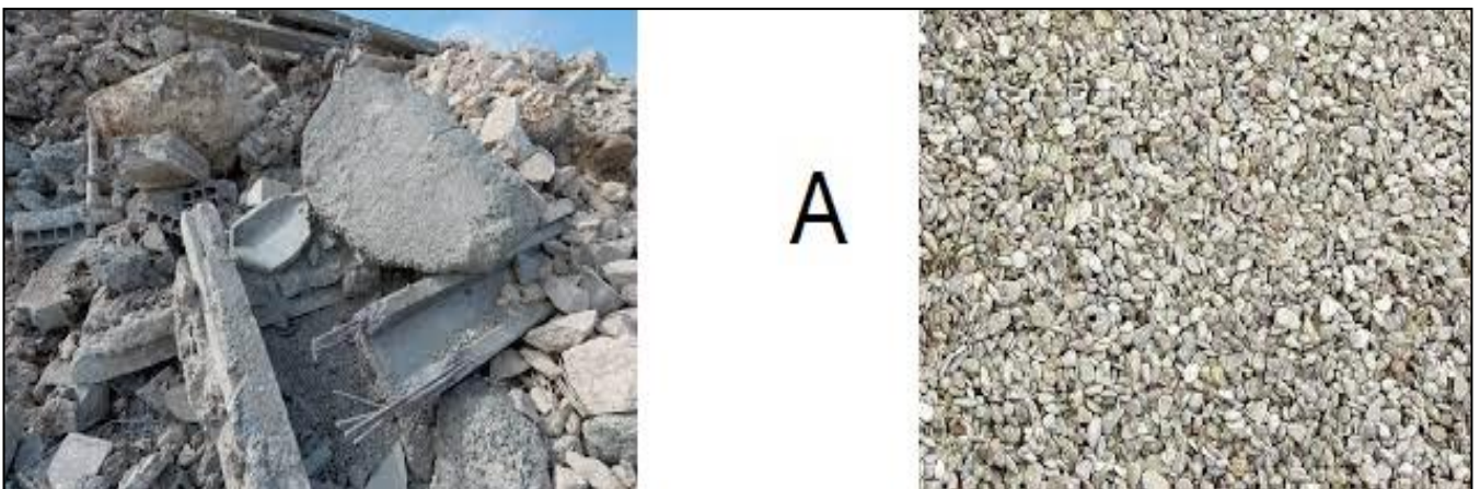
Fig.2.4: granulat de béton de démolition.
