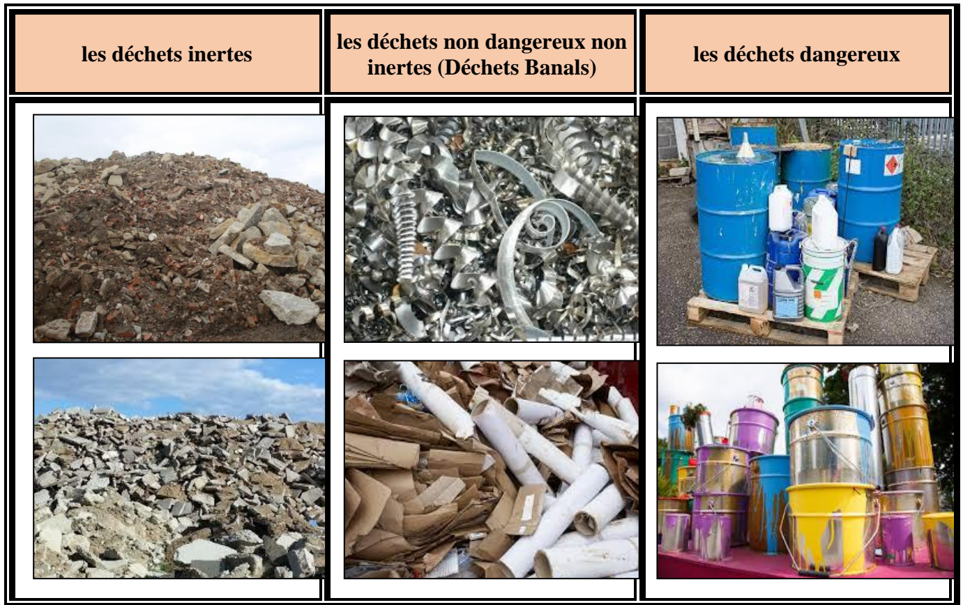
Fig.2.2. Classification déchets de chantiers
