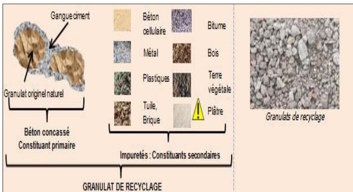
Fig.2.8 La forme du granulat de recyclage et différent types
