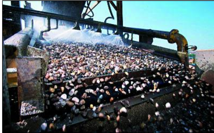
Fig 1.2 Lavage industriel des gravillons
