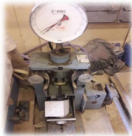
Figure 4.18 Appareil la Presse Hydraulique de Traction par flexion a 3point .
