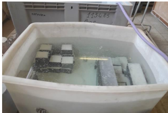
Fig 4.6. Conservation des éprouvettes immergées dans l'eau.
