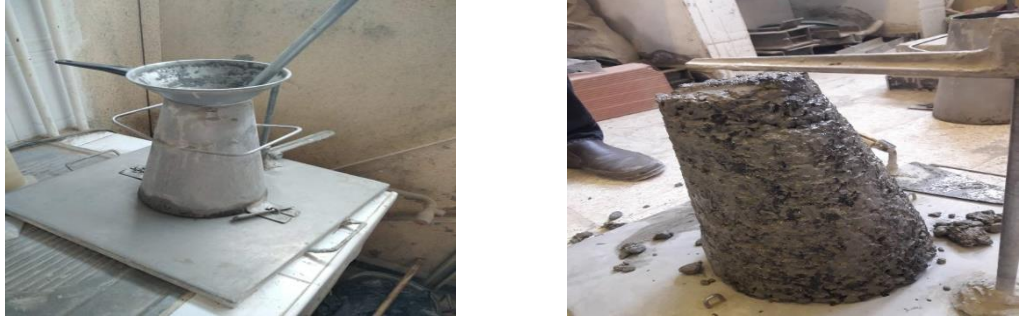
Fig 4.4. Appareillage de cône d'Abrahms
