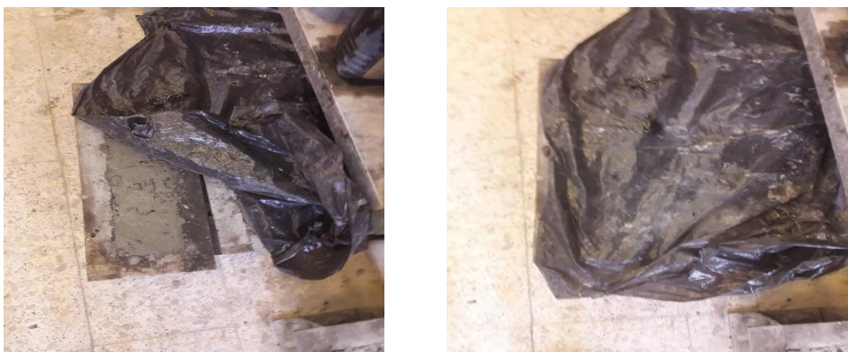
Fig 4.5. Conservation des moules avec un film plastique.
