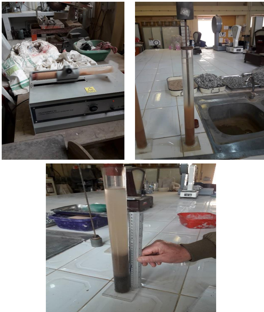
Figure 3.12 Photos expérimentals de l'équivalent de sable
