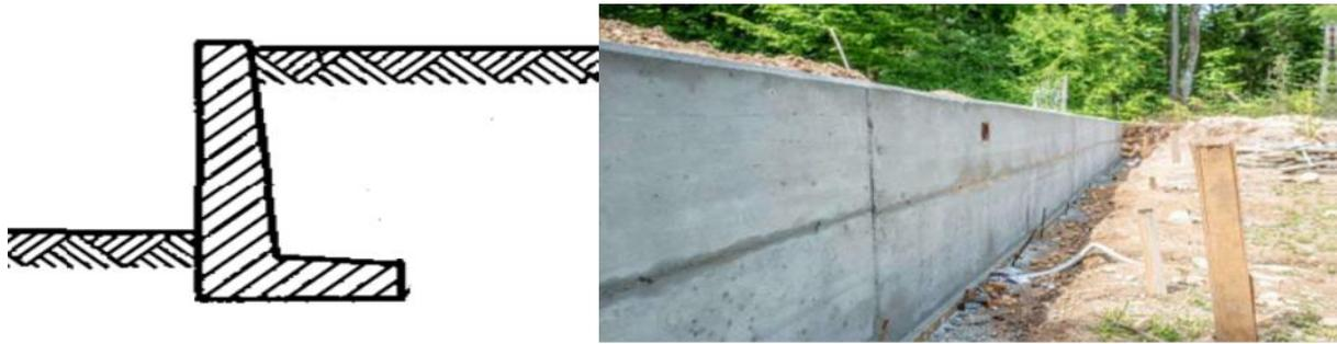
**Figure 1.2 Exemple de mur poids en béton.**
