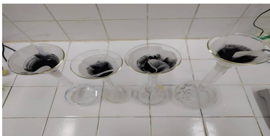
Figure I.5 :Lavage et filtration du charbon actif
