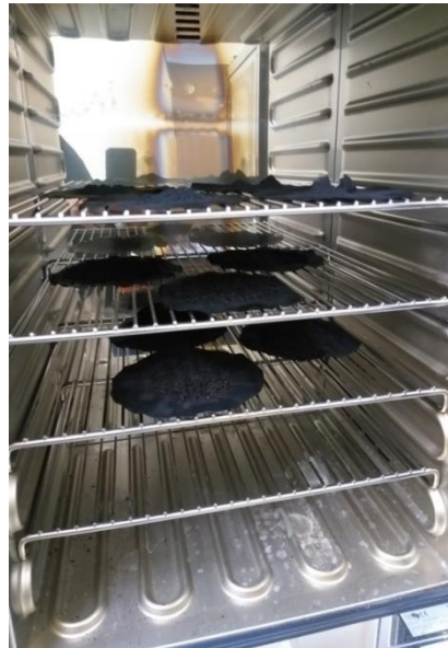
Figure I.3 : L'activation du charbon préparé à partir des noyaux de dattes
