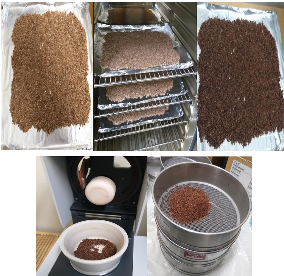
Figure I.2 : Les étapes de la préparation du charbon brut issu des noyaux de dattes
