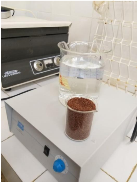
Figure I.3 : L'activation du charbon préparé à partir des noyaux de dattes
