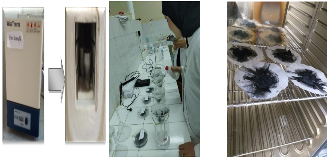
Figure I.4 : La carbonisation du charbon après l'activation
