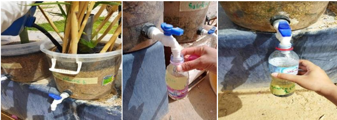
Figure 9: Photos montrant le remplissage des filtres plantés avec l'eau usée, et le Prélèvement
