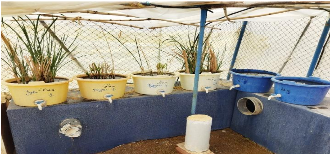
Figure I.10 : Irrigation des filtres avec l'eau usée.
