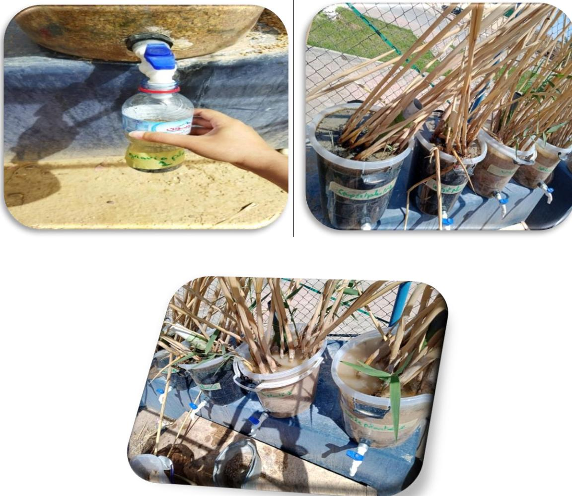
**Figure III.5** : filtre planté de phragmite et le prélèvement
