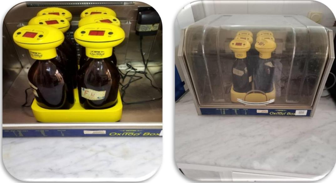
**Figure III.8 :** OxiTop® 6 postes et Enceinte
