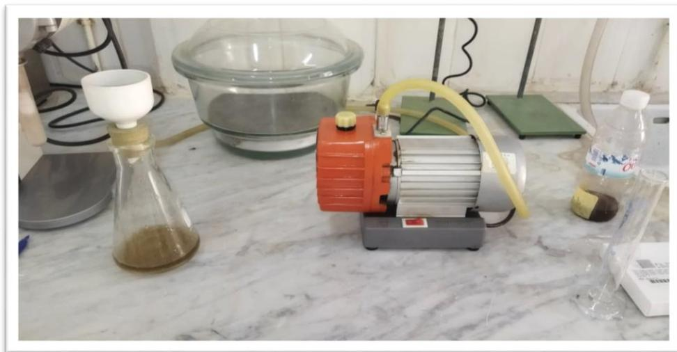
**Figure III.12:** filtre la matière en suspension
