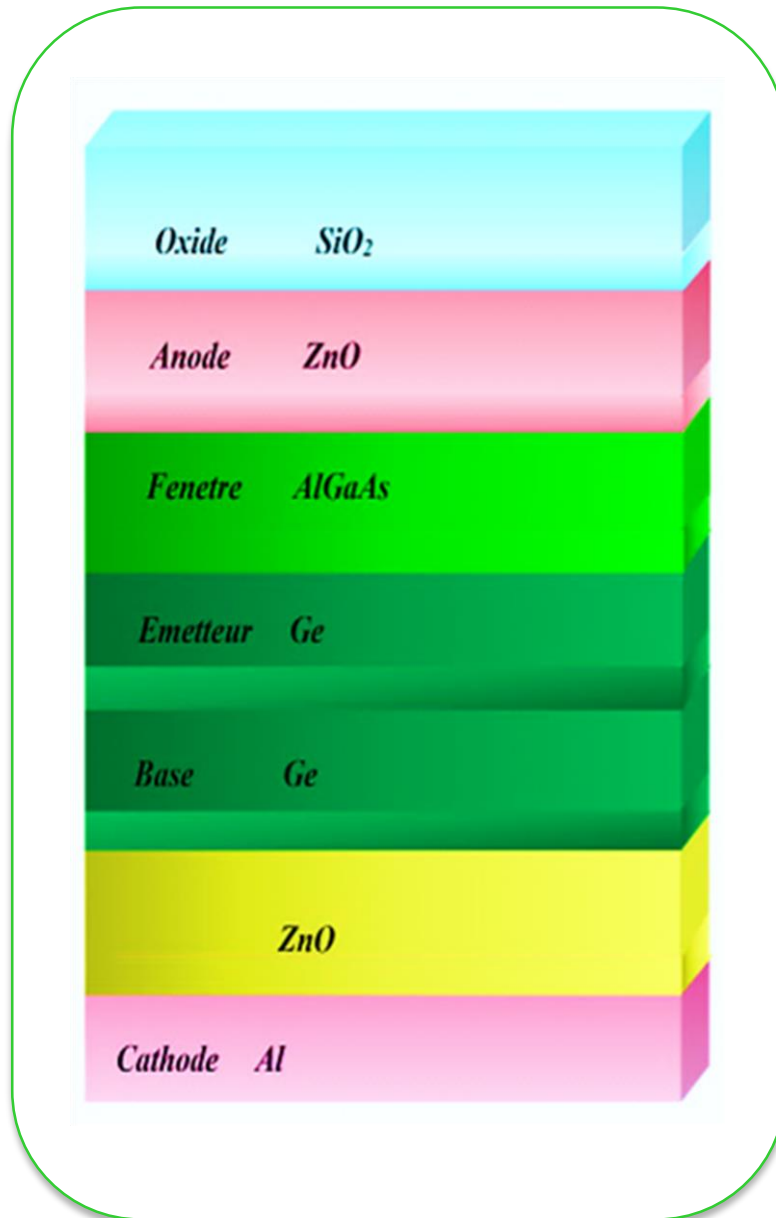
Figure III.10 : Schéma de la cellule solaire à base de Ge.
