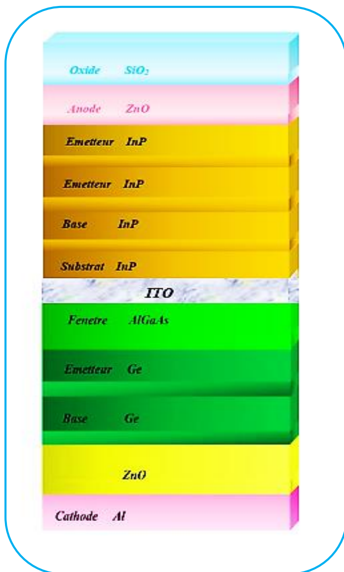
Figure III.14 : Structure de la cellule solaire à double jonction (InP/Ge).
