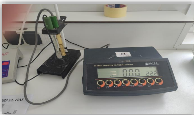
Figure 8 : Conductivimètre (ADE, Biskra).
