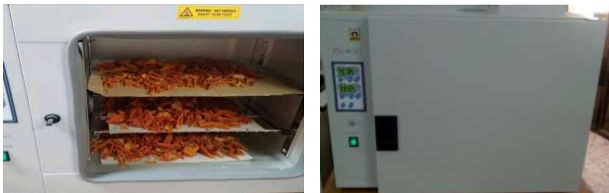
**Figure III.2:** Les écorces d'orange séchées dans l'étuve à 80°C pendant 4h.
