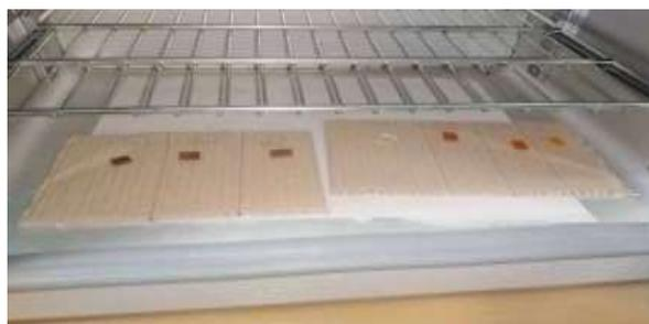
**Figure III.17:** Les Échantillons carrés au four à 80 °C pendant 20 minutes
