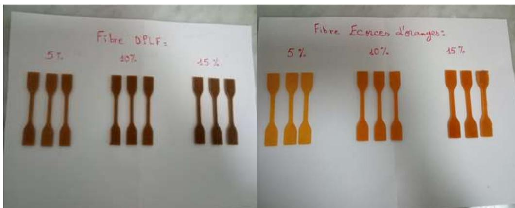
**Figure III.12** : La forme des éprouvettes soumises à un essai de traction.
