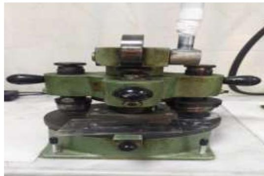
**Figure III.11** : Préparation des éprouvettes et Emporte-pièce.
