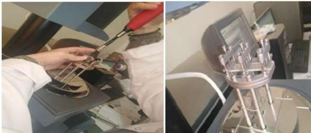
**Figure III.27 :** Installation de l'échantillon dans la machine
