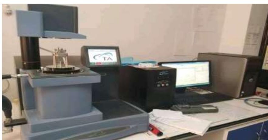
**Figure III.24** : Machine DMA de marque DMA Q 800.
