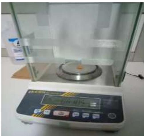
**Figure III.18** : Pesée des échantillons ( $m_0$ ) avec la balance analytique utilisée.
