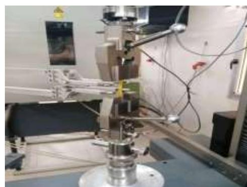
**Figure III.14 :** Éprouvette d'essai mise en place dans la machine de traction
