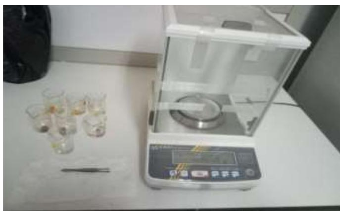
**Figure III.20** : Pesée des échantillons (m) après l'immersion.
