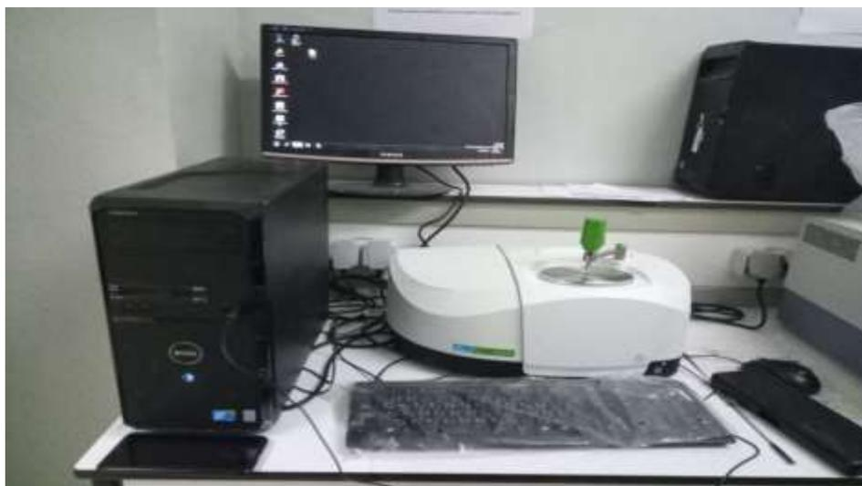
**Figure III.22 :** Spectrophotomètre à transformée de Fourier.
