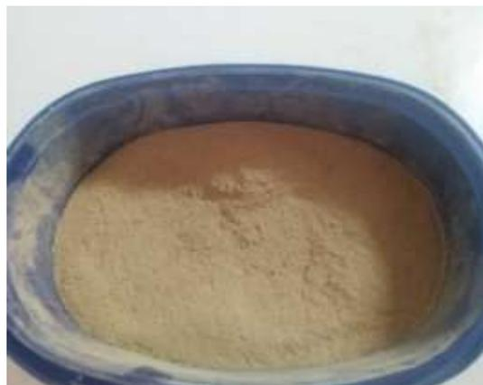
Figure III.6 : Broyage et Tamisage de la fibre DPLF
