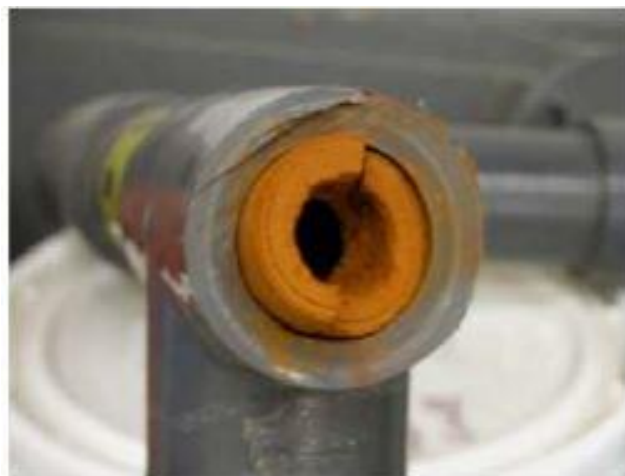
Figure II.3 Précipitation des Ca et Mg.[12]
