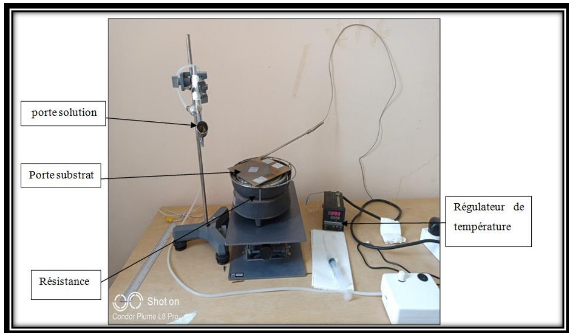
Figure (II-3) : Schéma général d'un procédé de dépôt par spray pneumatique.
