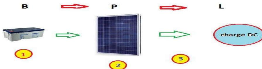
Figure 1-29 Procédure mise en marche d'un système PV, charge DC
