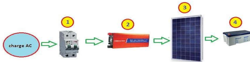
Figure 1-28 Procédure d'arrêt d'un système PV, charge AC
