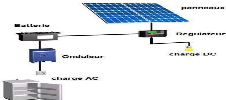
Figure 1-11 Principe de fonctionnement d'un système photovoltaïque autonome
