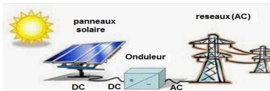
Figure 1-6 modes d'exploitation d'un système photovoltaïque (connecté au réseau)
