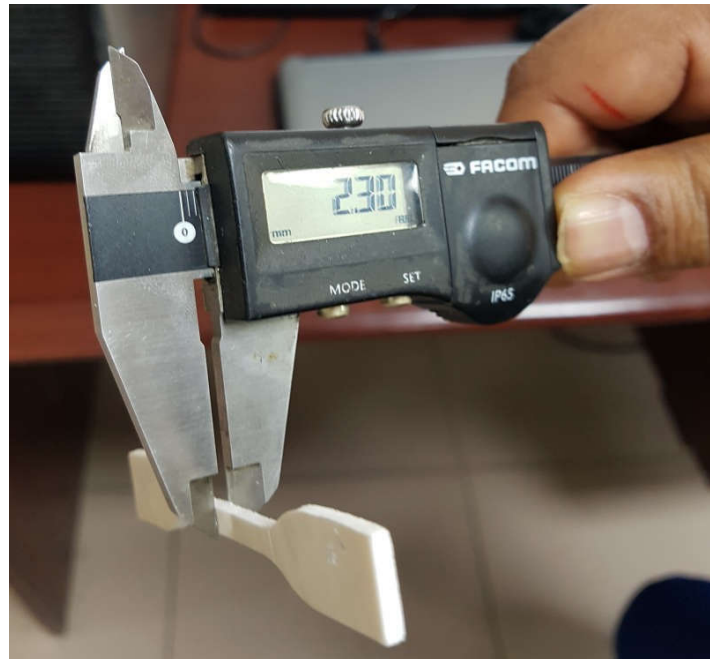
Figure IV.8 : mesure l'épaisseur par pied à coulisse
