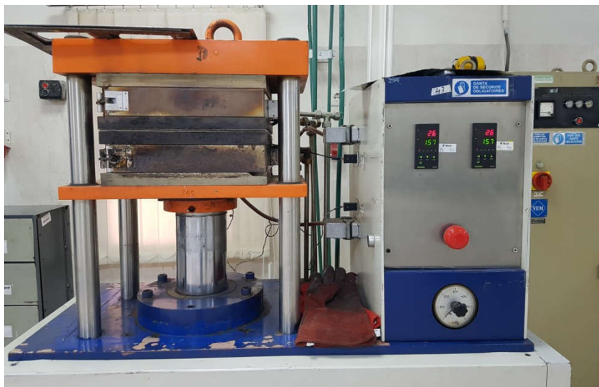
Figure IV.4 : Presse hydraulique de type «SCHWABENTHAAN POLYSTAT 300»
