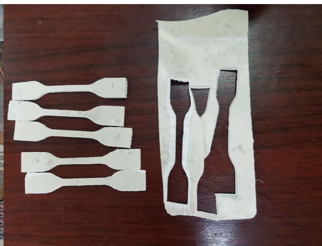
Figure IV.7 : Les éprouvettes obtenues
