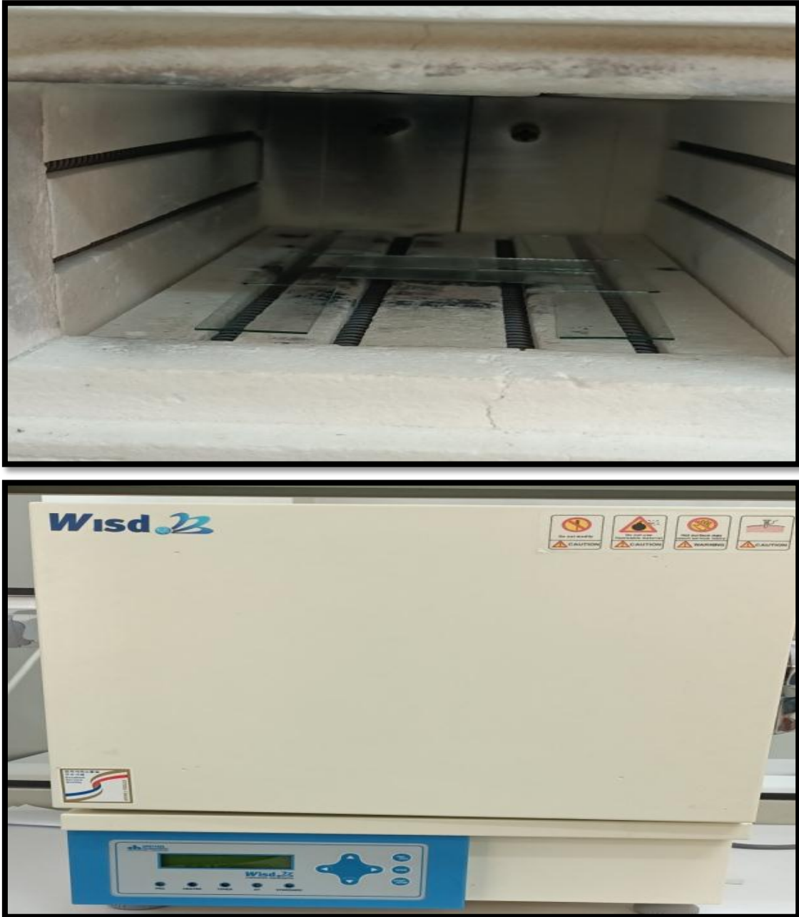
Figure II.5 :Four à moufle daihan scientific FH-05 digital, laboratoire de physique des couches minces et application (LPCMA), Université de Biskra.
