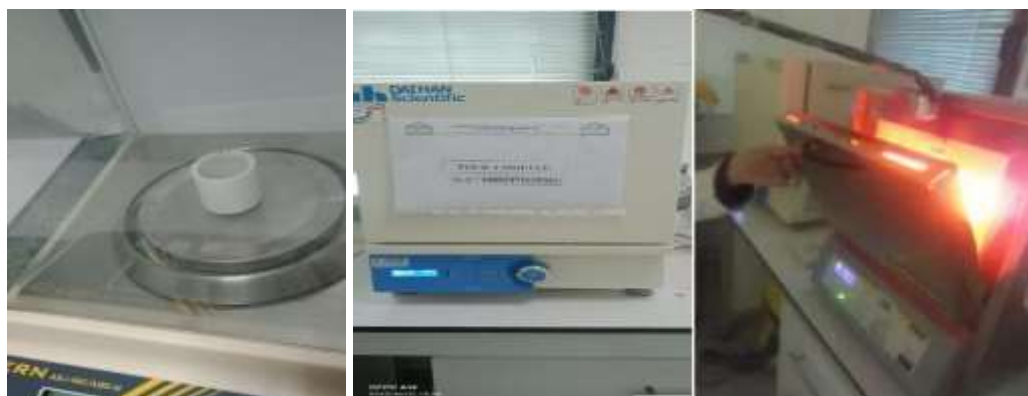
Figure III.5 : les étapes de la détermination de perte au feu.
