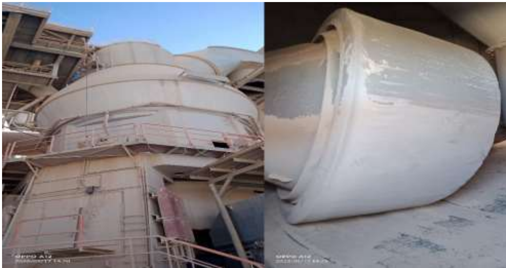
Figure I.16 : Le broyeur de cru (VRM)
