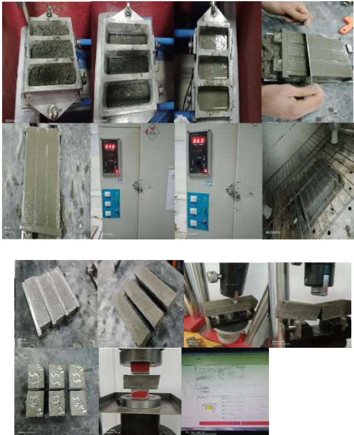
Figure III.6 : les étapes de la détermination de résistance à compression.
