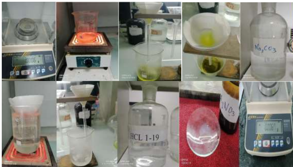
Figure III.4 : les étapes de la détermination de résidu insoluble.
