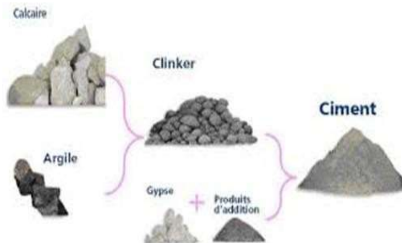
Figure I.6 : Principe de fabrication des ciments
