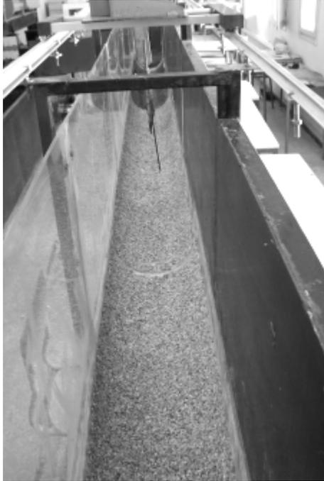
**Photographie 3 : Grains de gravier uniformément répartis sur le fond du canal profilé en U testé.**
