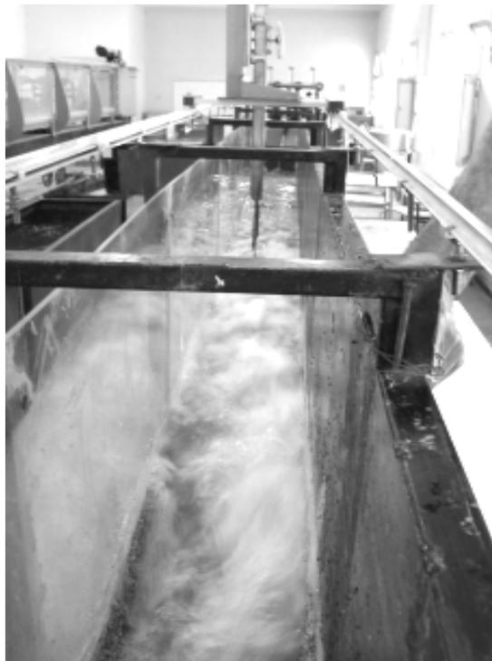
**Photographie 4 : Ressaut hydraulique évoluant dans un canal profilé en U à fond rugueux. Vue de l'amont.**
