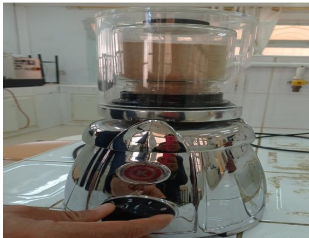
Figure III.3: broyage des pelures de figue de barbarie
