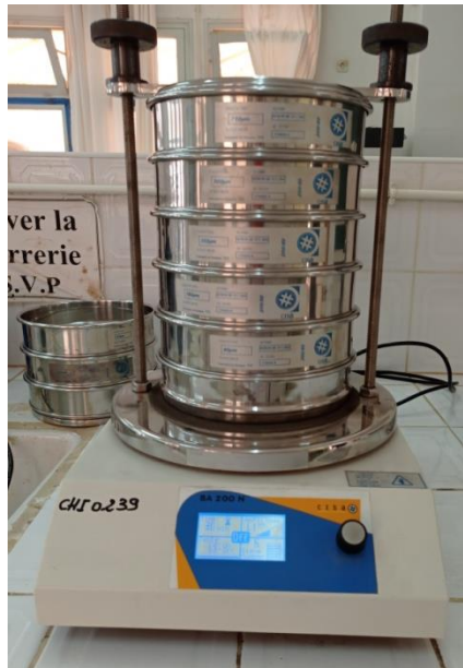
Figure III.4: tamisages des pelures de figue de barbarie
