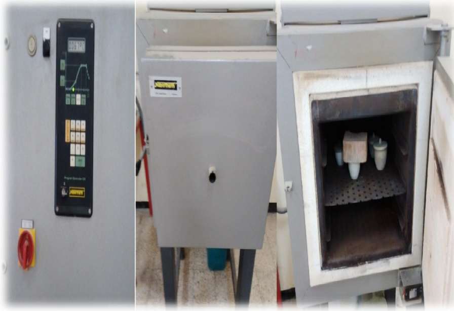
Figures III.8 : Four à moufle utilisé dans l'activation du bio-charbon [four a été fourni par le Dept Mécanique de l'Université de Biskra]
