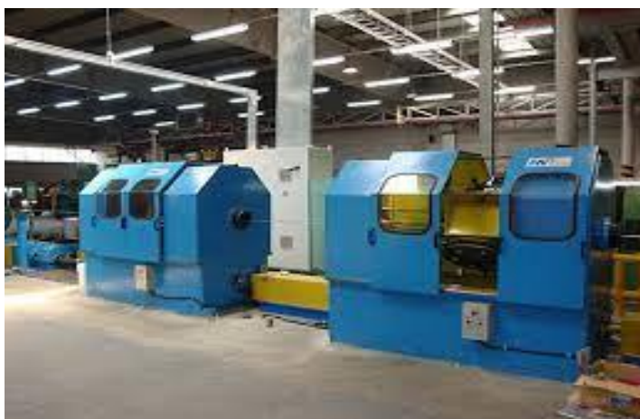
Figure I. 9: ligne enveloppeuse les Câbles électrique.
