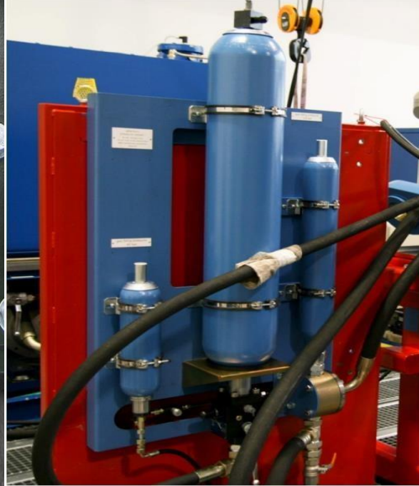
Figure II. 15 : Accumulateur de pression du circuit principal de pression.
