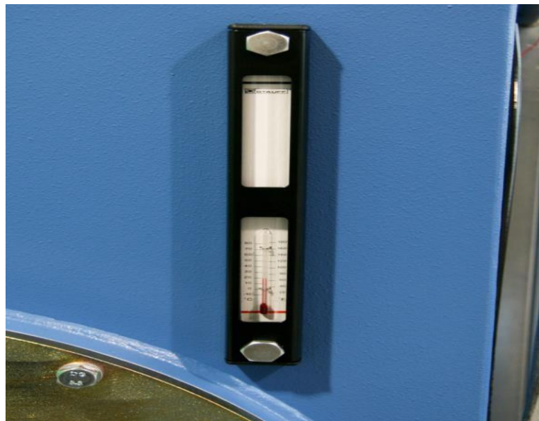
Figure II. 7 : Indicateur de niveau d'huile.
