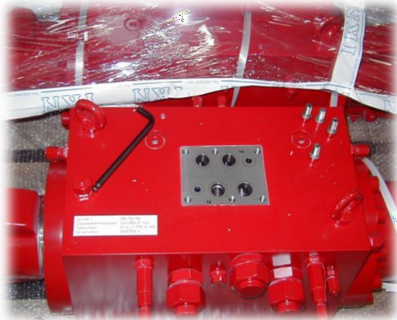
Figure II. 12 : Soupapes de décharge de pression.
