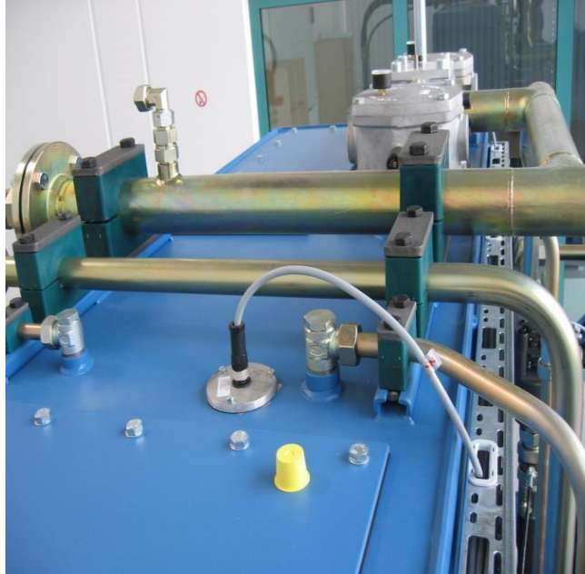
Figure II. 8 : Capteur de température d'huile et de niveau d'huile (analogique).
