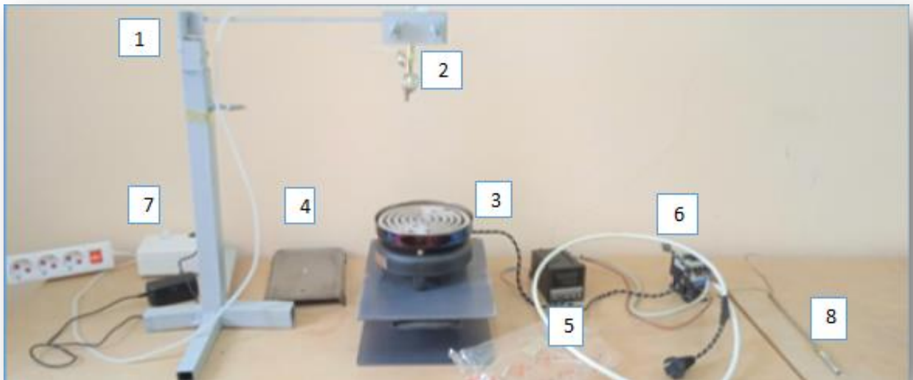
Figure III.1 : schéma du banc de déposition de couche mince par le technique spray pneumatique.
