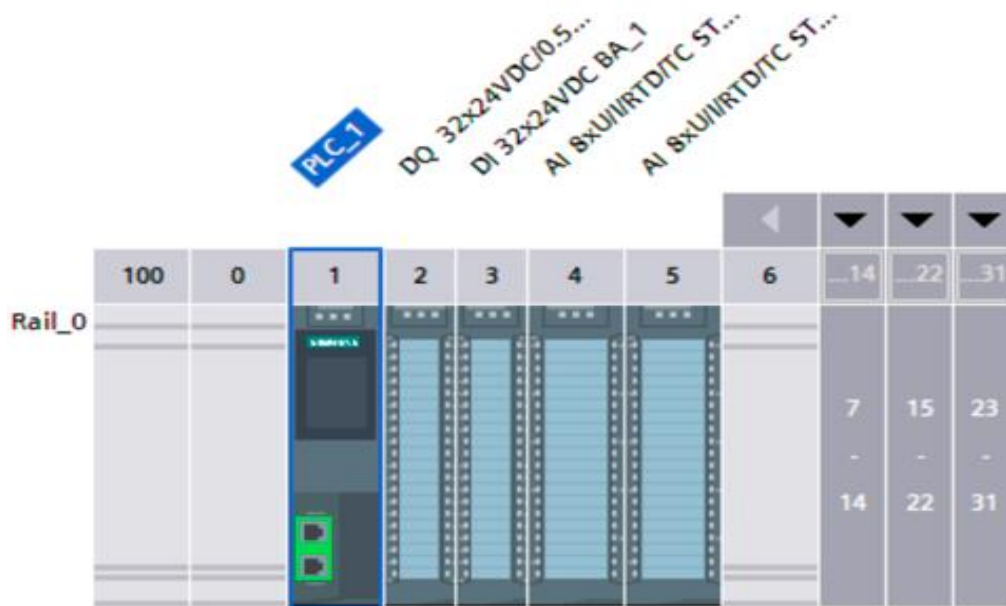
Figure IV-4 : Configuration de l'automate S7-1500
