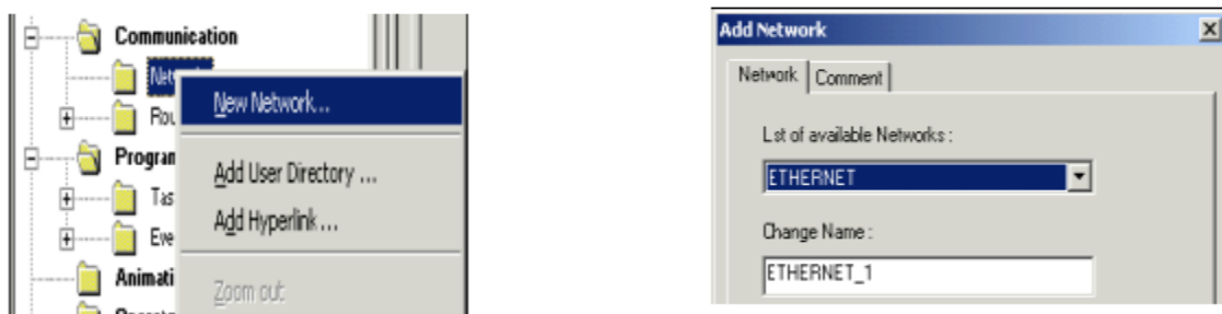
Figure III.9:Création d'un réseau ETHERNET.
