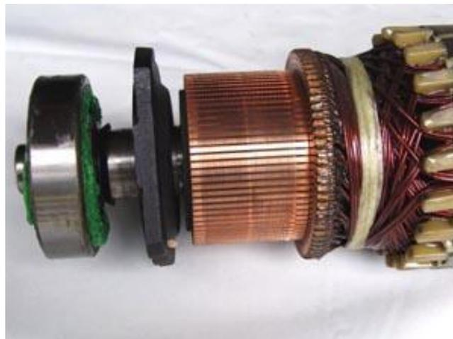
**Figure I.5:** Le collecteur de la machine à courant continu
