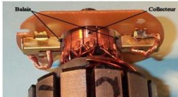
**Figure I.6:** Le dispositif collecteur / balais d'un moteur à courant continu
