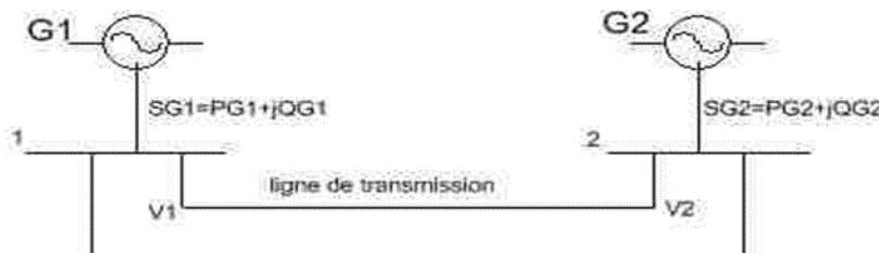
Figure 1.6: Exemple d'un système de transport.
