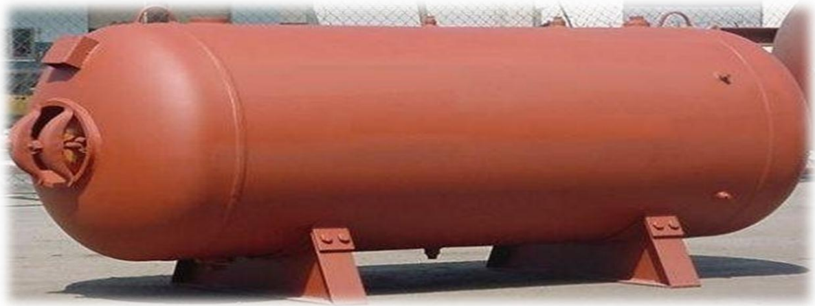
Figure (II. 12) : Réservoir sous pression constitué d'un tuyau d'acier horizontal. [30]
