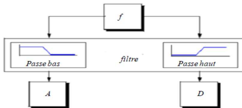
**Figure (III. 6): Décomposition du signal  $f$  en approximations et détails**
