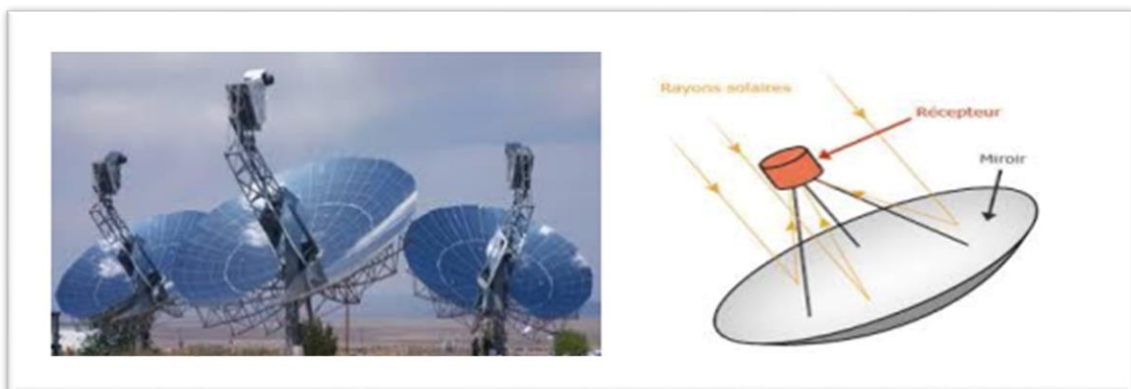
Figure II.3 : centrale thermodynamique parabolique.
