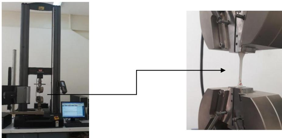
**Figure. II.9** Machine de traction type INSTRON modèle 5969.
