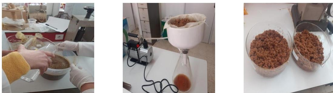
Figure II.3 : Modification chimique de la fibre par la soude NaOH
