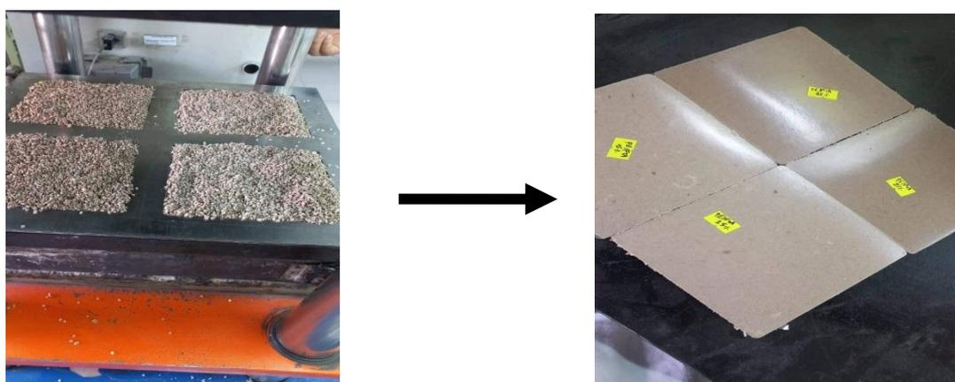
**Figure. II.6** Les plaques des composites obtenus après moulage.
