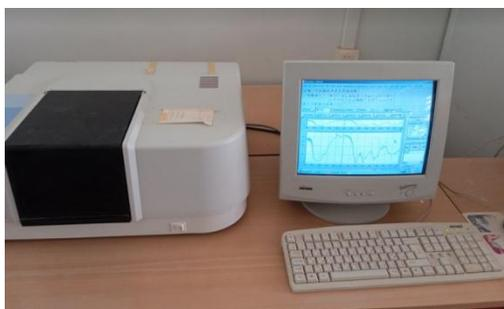
**Figure II.8 Spectrophotomètre SHIMADZU – FTIR 8400S.**
