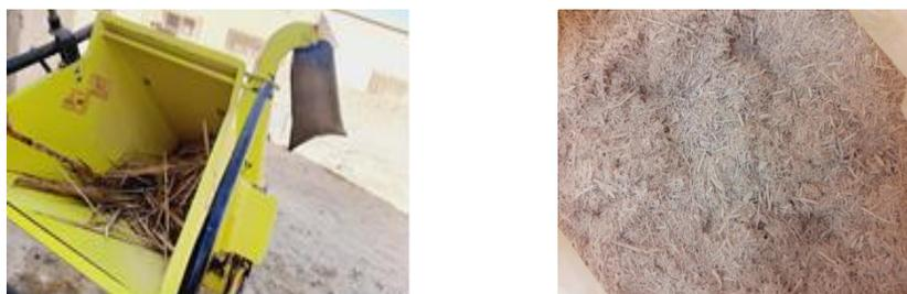
Figure II.2: broyage des fibres de palmier dattier
