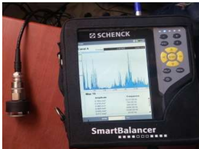
Figure III-3 : appareille de SCHENCK et le capture de vibration [18]
