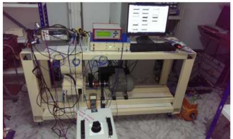
Figure III-1 : Photo du banc d'essai dédié à l'analyse vibratoire [18].
