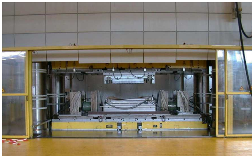
Figure 8 –Exemple de presse utilisée en hydroformage.
