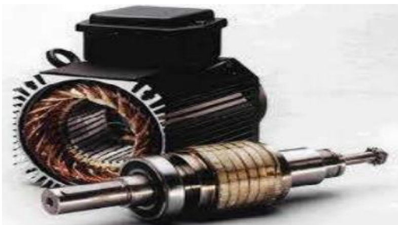
Figure I.1: Représentation de la machine synchrone à aimants permanents
