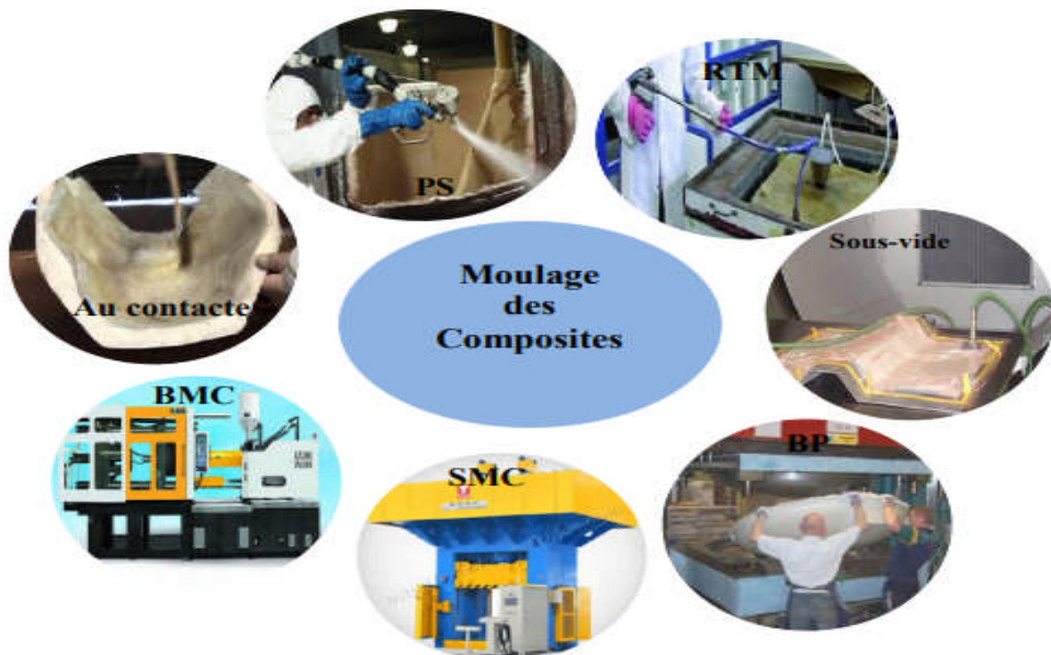
Figure I.3.2. Quelques procédés de mise en œuvre des composites [6]
