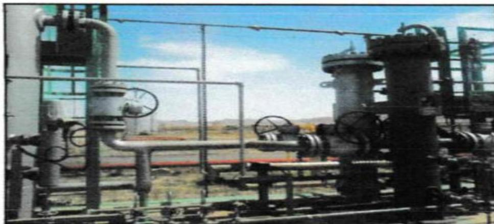
Figure I-12. Système filtration de gaz.
