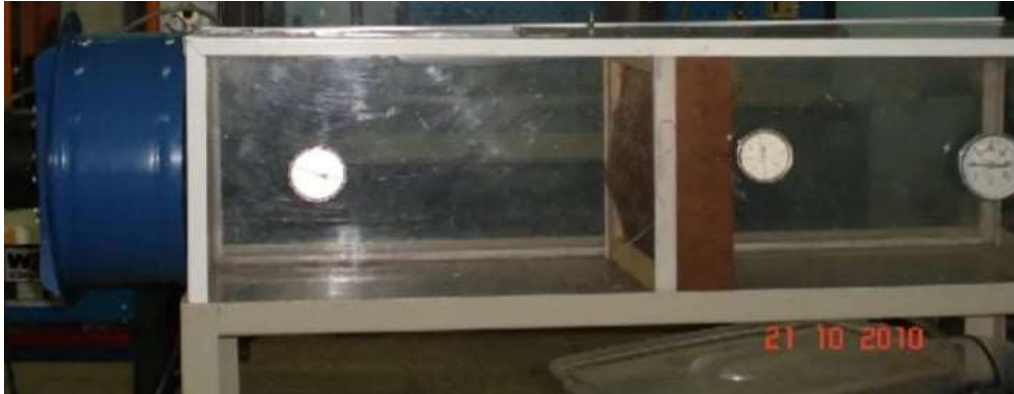
Figure II.7: Banc d'essai expérimental avec ventilateur de soufflage de l'air [10].
