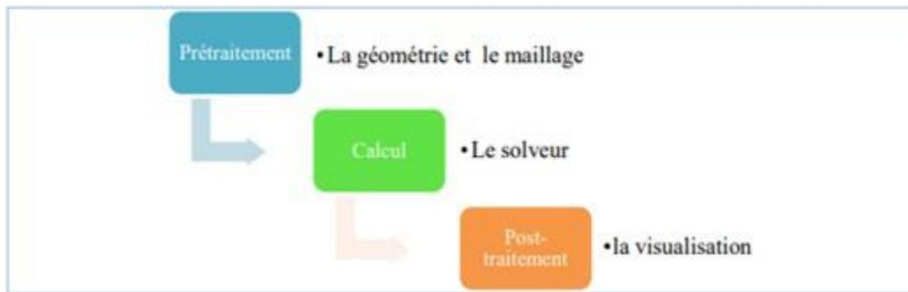
Figure 2.1. Processus du fonctionnement d'un code CFD.
