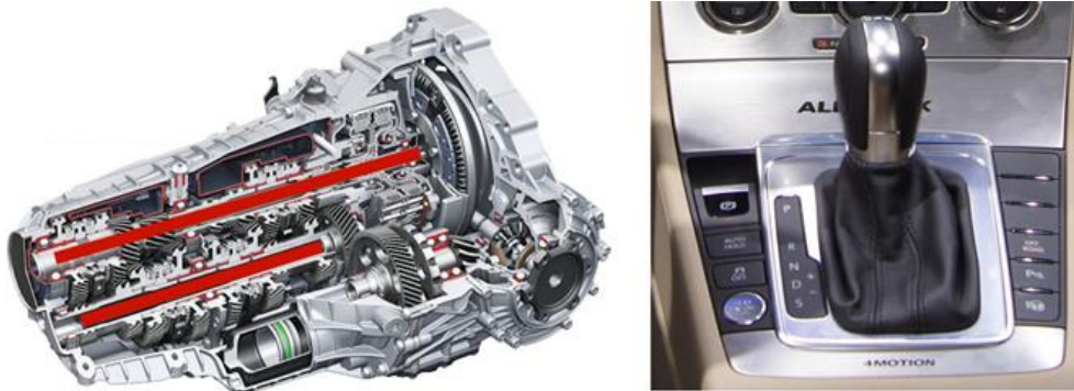
Figure 1-9 Exemple d'une modèle de la boîte de vitesses robotisée [4]
