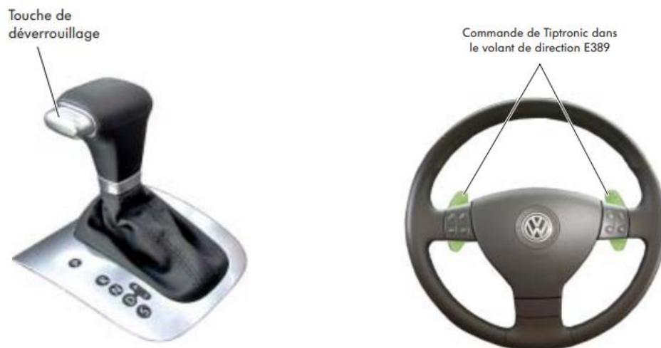
Figure 1-15 Levier sélecteur et les palettes de commande de Tiptronic [6]
