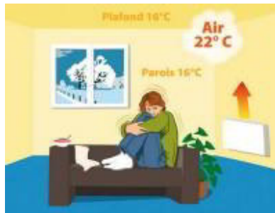
Figure (I-9) : affichage température des parois
