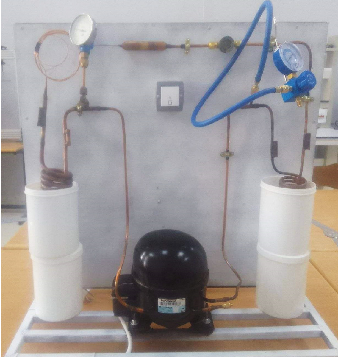
Figure (IV-1) : Machine frigorifique à compression mécanique
