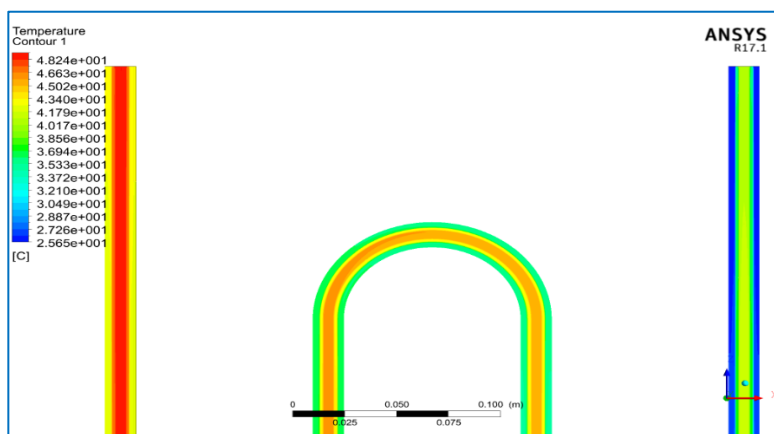
Figure V.8 : Représentation de la distribution de la température totale à l'intérieur de l'échangeur de chaleur coaxial dans le cas d'utilisation de nanofluide hybride \Phi=0.03 comme fluide caloporteur à l'écoulement Contre-courant Q_{vch} > Q_{vf} .
