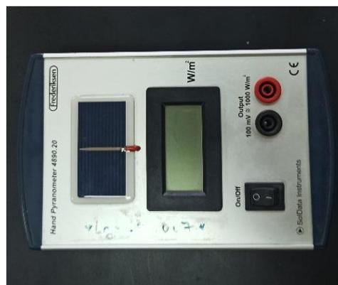
**Figure III.15:** Hand pyranometer 4890.20.
