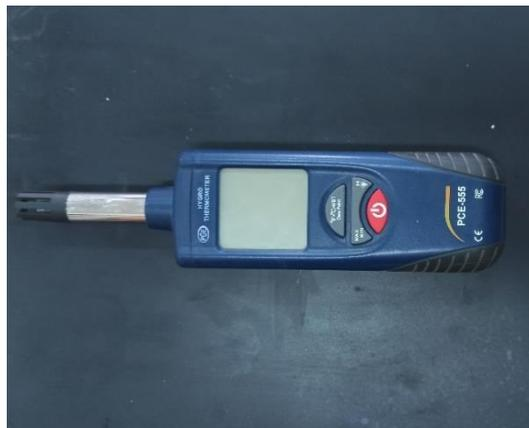
**Figure III.14:** Hygrometer (Model PCE-555).
